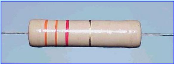
Aspecto de un resistor de film de carbón
