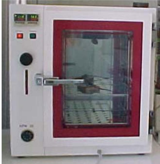
Figura 42. Cámara térmica KPK 35
