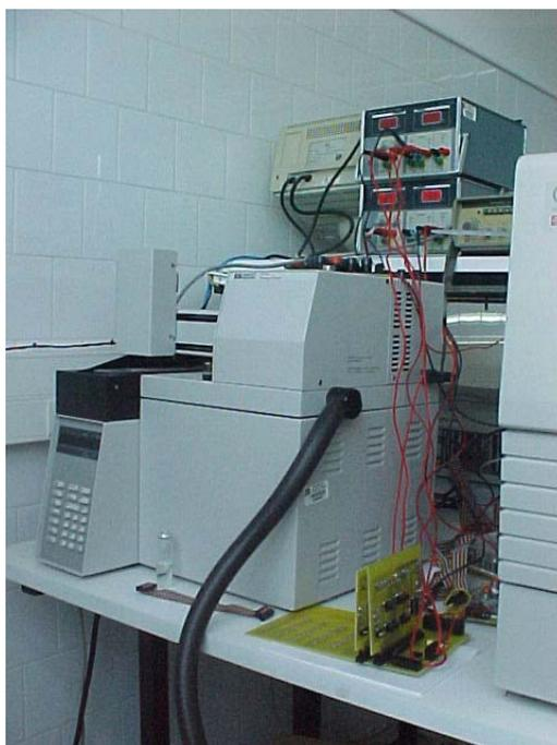
**Figura 71.** Headspace Autosampler HP conectado al sistema de control de temperatura.
