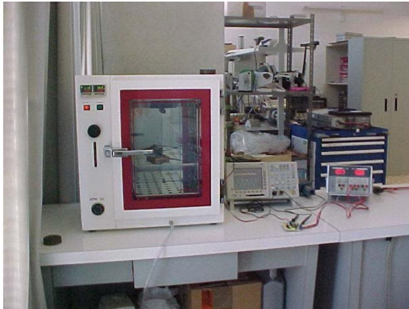
**Figura 44.** Montaje para el ensayo realizado con la cámara térmica
