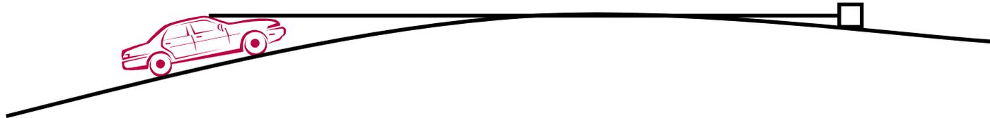
**Sentado en un automóvil, debe ver un objeto de altura  $H_2$  sobre el pavimento a una distancia mayor o igual a la distancia de detención.**
