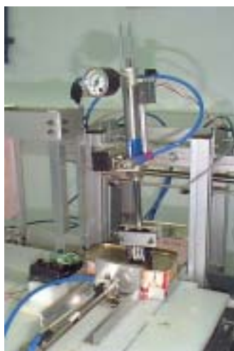
La figura muestra dos actuadores lineales de doble efecto. Uno de ellos es el que se encarga de posicionar y sujetar la lata mientras que el segundo imprime los controles de elaboración y fecha de vencimiento
