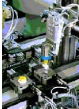
Traslado y ensamblado de elementos en la industria electrónica, mediante dispositivos neumáticos.
