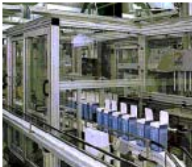
Empaquetado de alimentos realizado a través de cintas transportadoras y dispositivos actuadores neumáticos
