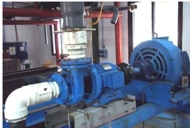
Figura 1: Bomba centrífuga acoplada a freno dinamométrico.
