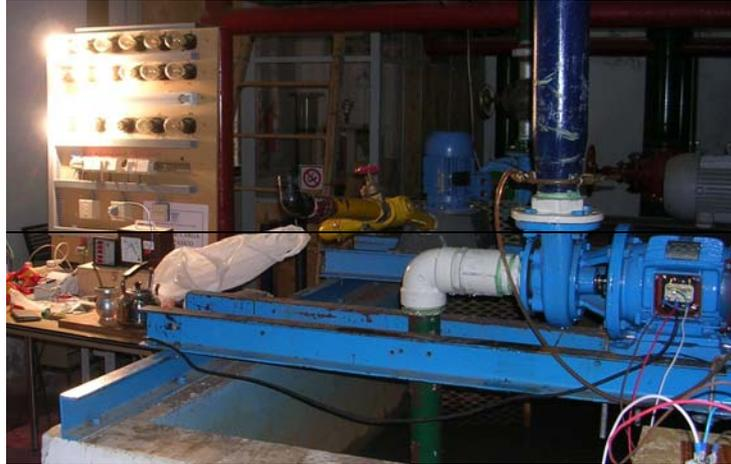
Figura 8: Ensayo de la bomba centrífuga generando, tablero de mediciones y cargas.
