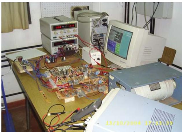
Figura 7. Convertidor estático implementado
