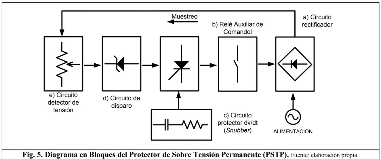
**Fig. 5. Diagrama en Bloques del Protector de Sobre Tensión Permanente (PSTP).** Fuente: elaboración propia.
