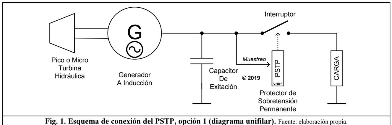
Esta configuración no desconecta el capacitor de excitación, por lo que en bornes del generador se seguirá teniendo la sobretensión detectada, más la sobretensión ocasionada al retirar la carga. Poniendo en riesgo el capacitor y el generador.
