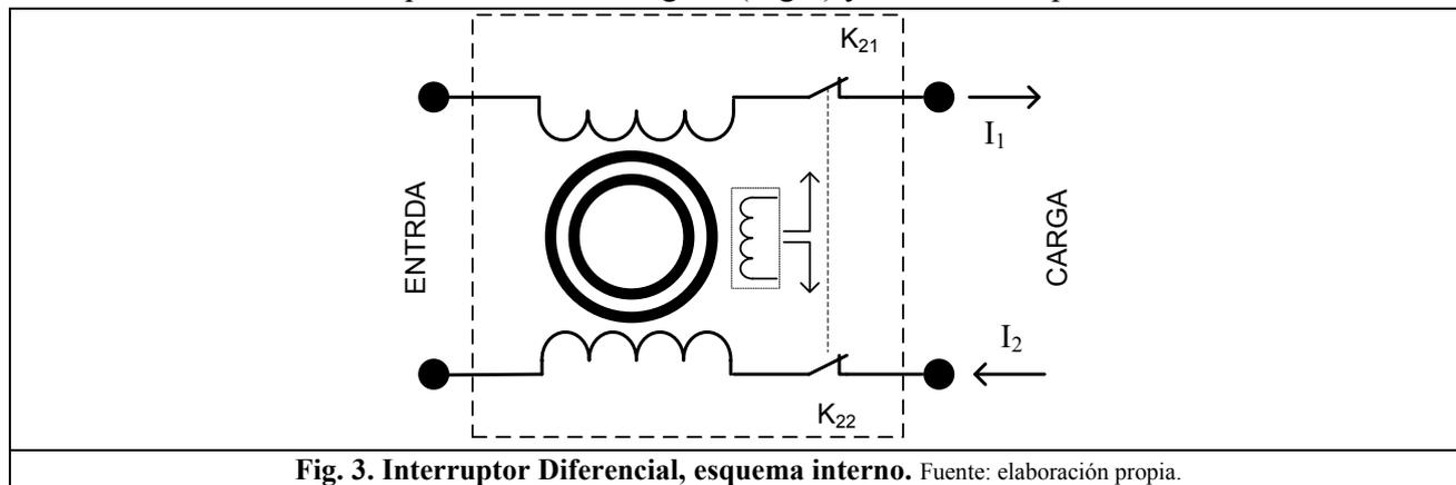
Fig. 3. Interruptor Diferencial, esquema interno. Fuente: elaboración propia.
