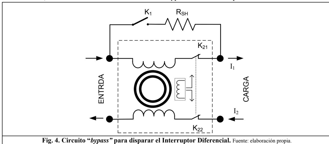
Fig. 4. Circuito "bypass" para disparar el Interruptor Diferencial. Fuente: elaboración propia.
