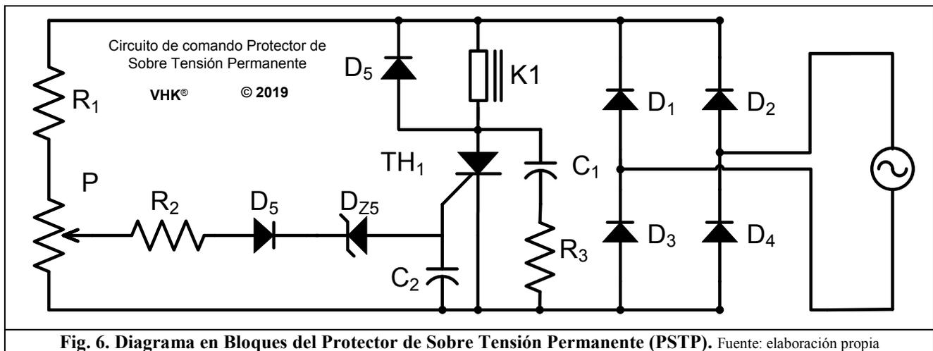
**Fig. 6. Diagrama en Bloques del Protector de Sobre Tensión Permanente (PSTP).** Fuente: elaboración propia
