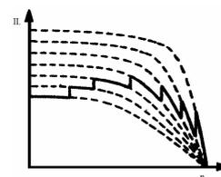
Figura 4 Corriente en el arranque
