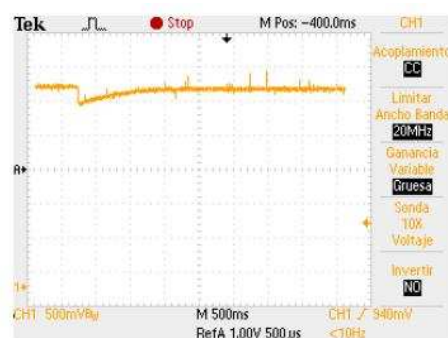
Figura 6. Resposta transitória da saída ou tensão controlada, v_o(t) para entrada de carga nominal.
