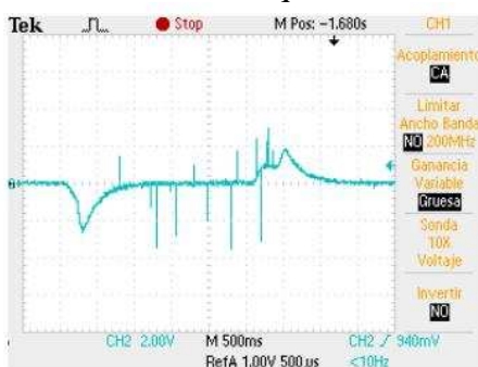
Figura 5. Resposta transitória da ação de controle u(t) para entrada e saída de carga nominal.
