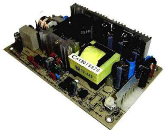
Figura 13.27. Fuente de alimentación conmutada.
