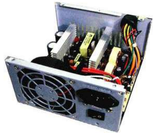
Figura 13.34. Fuente de alimentación conmutada.
