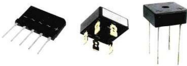
Figura 8.10. Puente rectificador integrado.
