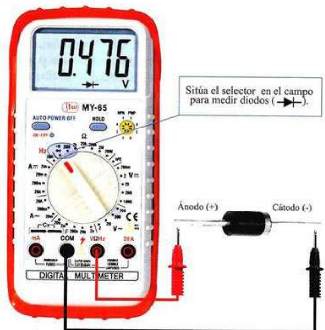
Figura 7.35. Comprobación de un diodo mediante el polímetro digital.
