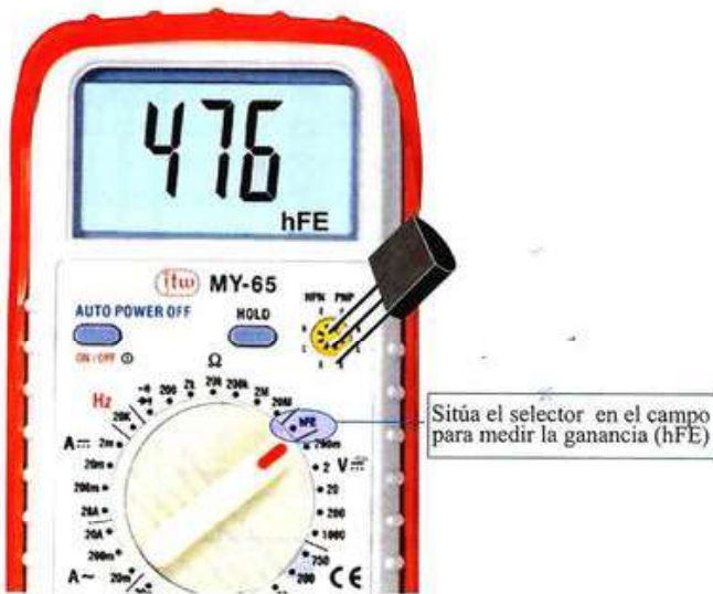
Figura 9.48. Medida de la ganancia de corriente.
