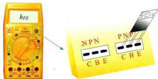
Figura 9.16. Medida de la ganancia mediante polímetro digital.
