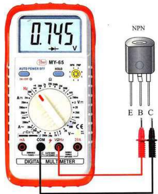
Figura 9.47. Polarización base colector.
