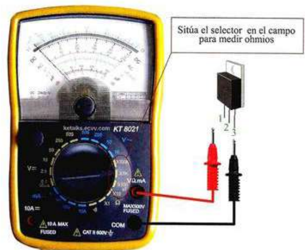
Figura 9.15. Identificación del tipo de transistor mediante un polímetro.
