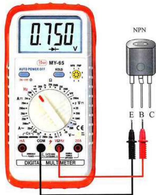
Figura 9.46. Polarización base emisor.
