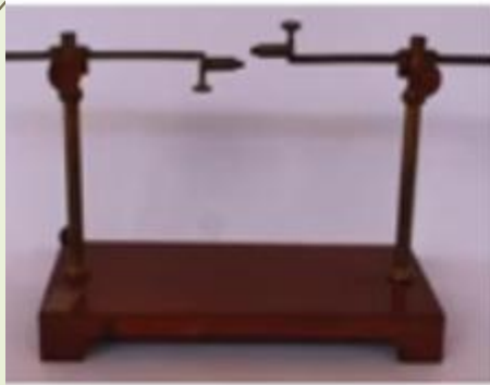
Sir Humphry Davy en 1800 inventó el generador que encendió el arco eléctrico. Electrodos de carbono.
