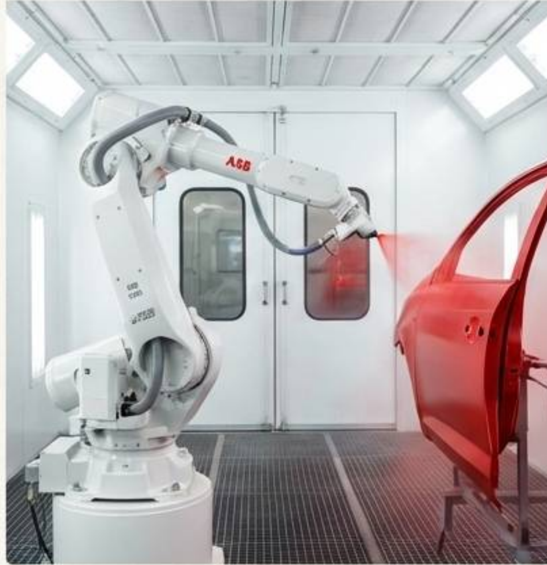
Aplicación de Pintura
