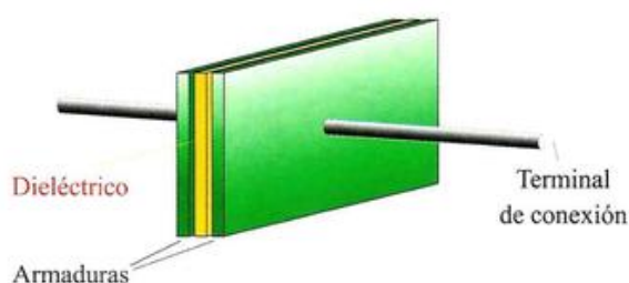
Figura 6.20. Constitución de un condensador.
