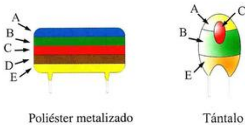
Figura 6.32. Códigos para diferentes tipos de condensadores.
