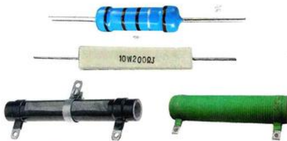
Figura 6.1. Resistencias para circuitos electrónicos.
