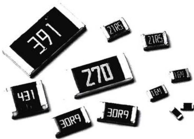
Figura 6.5. Marcado alfanumérico de resistencias SMD.
