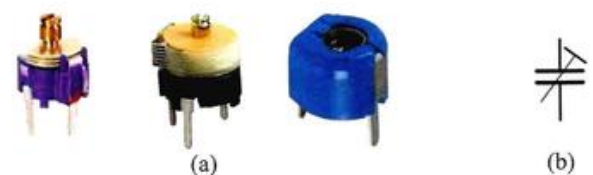
Figura 6.31. (a) Condensadores ajustables. (b) Símbolo.
