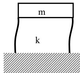
**Ejercicio 4** Una masa de 0,907 kg es conectada al extremo de un resorte con una rigidez de 7,0 N/cm. Determine el coeficiente de amortiguamiento crítico.
