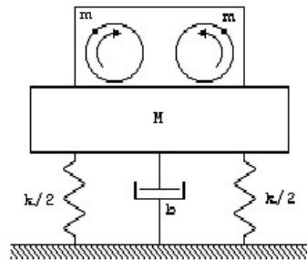
**Ejercicio 11.** Un radio de avión pesa 106,75 N y debe ser aislado de vibraciones del motor a frecuencias de 1.600 ciclos/minuto a 2.200 ciclos/minuto. ¿Qué deflexión estática deben tener los osciladores para un aislamiento del 85%?
