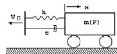
**Ejercicio 7** Un pistón de 4,5 kg se desplaza en un tubo con una velocidad de 15 m/seg y entra en contacto con un amortiguador y un resorte tal como indica la figura. Para el sistema oscilatorio resultante:
