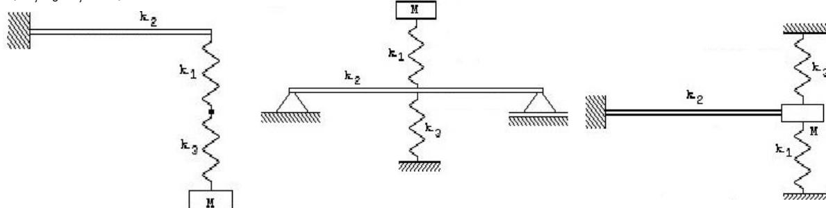
**Ejercicio 2.** Un sistema masa-resorte de valores  $m$  y  $k_1$ , tiene una frecuencia natural  $f_1$ . Si se añade un segundo resorte de constante  $k_2$  en serie con el anterior, la frecuencia natural se reduce a la mitad ( $0.5f_1$ ). se pide:
