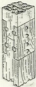
A TOPE CON PLATABANDAS REBAJADAS
