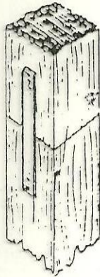
A TOPE CON CUBRE-JUNTAS SIN REBAJO
