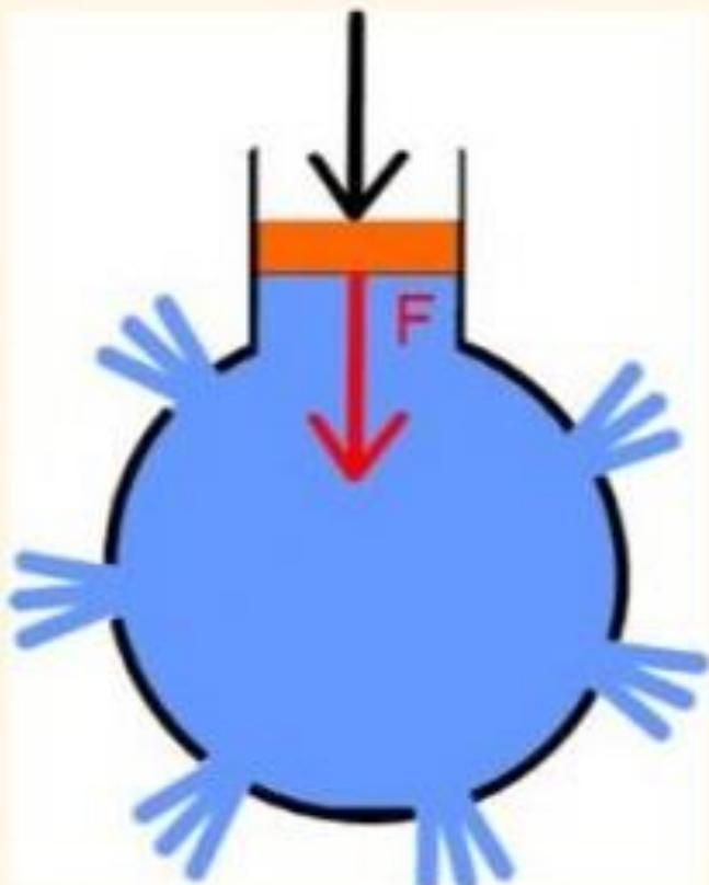
La presión aplicada en un punto de un líquido se transmite por igual en todas las direcciones.
