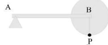
14 - En el instante representado, la aceleración del punto A tiene la dirección de su movimiento y el punto B que se encuentra sobre la curva de 180m de radio tiene una celeridad de 72 Km/h y en aumento. Si la aceleración de B observada desde A es cero en el instante mostrado, hallar la aceleración de A y de B en forma gráfica y analítica.
