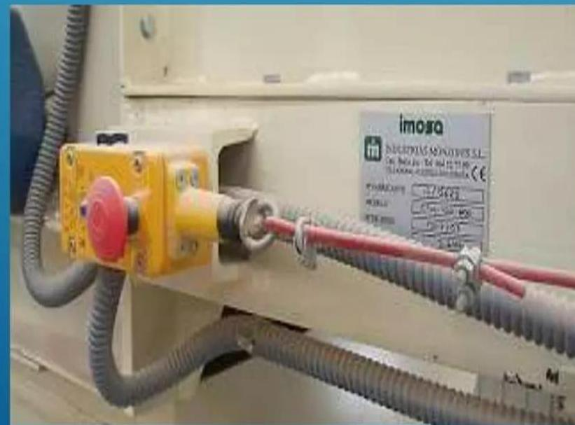
**Paradas de emergencia:** Es muy frecuente la presencia de paradas de emergencia de tirón. Al tirar del cable, se detiene el movimiento de la cinta.
