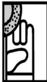
**2 - Resistencia al corte por cuchilla:** número de ciclos necesarios para cortar la muestra a una velocidad constante.
