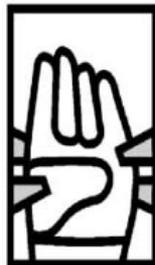
**4 - Resistencia a la perforación:** fuerza necesaria para perforar una muestra con un punzón normalizado
