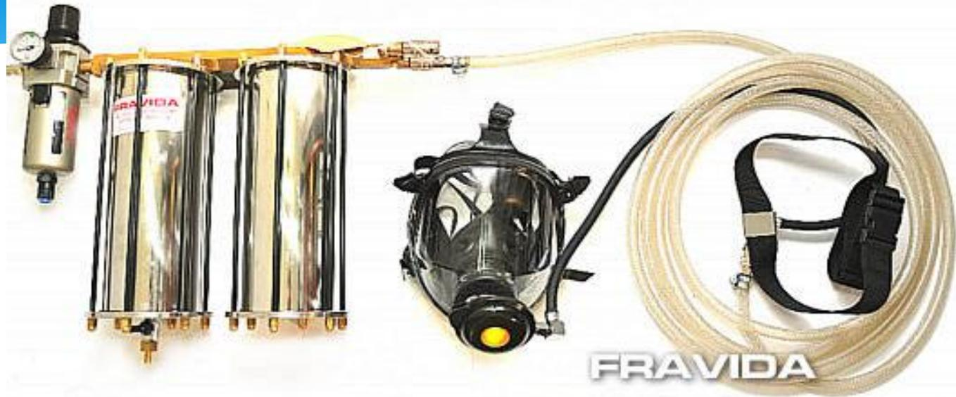
**Filtro de línea de aire** : contiene un cartucho cambiabile, con capas filtrantes, construidas en material sintético cardado, tipo fieltro y lechos intercalados de carbón activado y de alúmina activada, trabajando en secuencia para suplir el aire limpio al trabajador.
