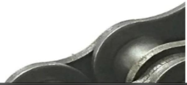
Se está diseñando una transmisión de cadena para una máquina industrial. Ha seleccionado una cadena de rodillos con un **paso (P) de 15.875 mm** (que equivale a 5/8 de pulgada, un paso común en cadenas industriales).
