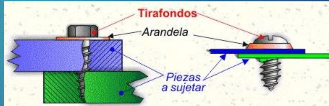
El diseño de la rosca se hace en función del tipo de material en el que ha de penetrar. Se fabrican tirafondos con roscas especiales para chapas metálicas (aluminio, latón, acero...), maderas (naturales, aglomerados, contrachapados, DM...), plásticos, materiales cerámicos, tacos...
