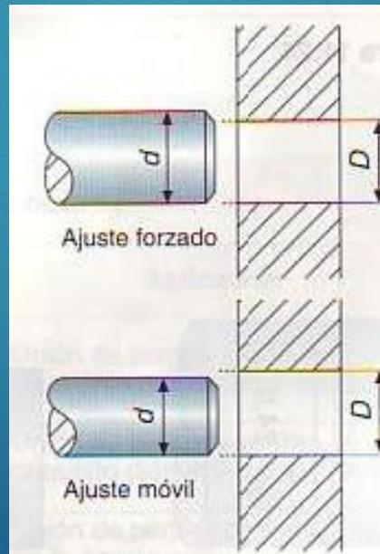
Podemos diferenciar pues, dos elementos: el **eje** es la pieza interior y el **agujero** es la **pieza exterior**
