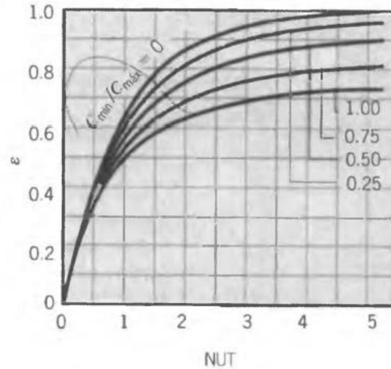
**FIGURA 11.17** Eficiencia de un intercambiador de coraza y tubos con dos pasos de coraza y cualquier múltiplo de cuatro pasos por los tubos (cuatro, ocho, etc., pasos de tubo) (ecuación 11.32 con  $n = 2$ ).
