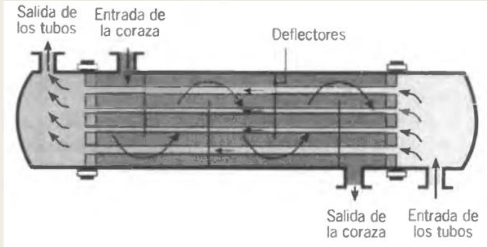
Con un paso por la coraza y un paso por los tubos (modo de operación de contraflujo cruzado).
