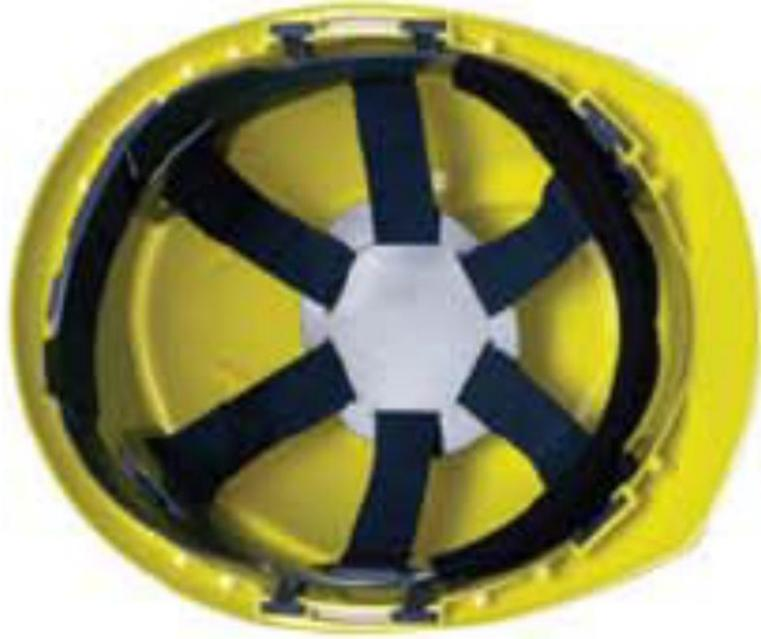
La capacidad protectora de un casco se basa, principalmente, en el espacio amortiguador de golpes, que se mantiene entre la coraza y la suspensión de ésta. Para no restarles resistencia a roturas y para que el casco evite lesiones, este espacio debe quedar libre.
