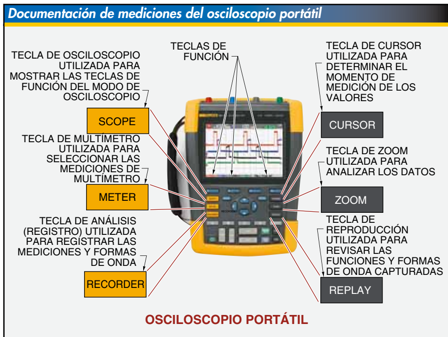
Figura 5-1. Los botones SCOPE, METER, RECORDER, CURSOR, ZOOM y REPLAY del osciloscopio portátil se utilizan para establecer el tipo de medición que se va a realizar y para registrar, documentar y analizar las lecturas.
