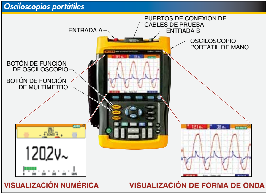
Figura 3-5. Los osciloscopios portátiles son una combinación de un multímetro que toma y muestra lecturas de multímetro digital y un osciloscopio que muestra, registra y captura las mediciones de los datos en forma de onda que se pueden descargar en el PC.
