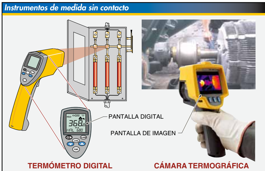
Figura 3-8. Entre los instrumentos de medida que se pueden utilizar para comprobar los componentes y circuitos eléctricos sin entrar en contacto físico se incluyen los termómetros digitales y las cámaras termográficas.
