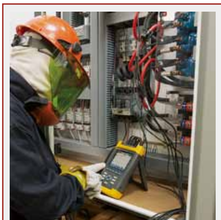
Figura 5-1. Los botones SCOPE, METER, RECORDER, CURSOR, ZOOM y REPLAY del osciloscopio portátil se utilizan para establecer el tipo de medición que se va a realizar y para registrar, documentar y analizar las lecturas.
