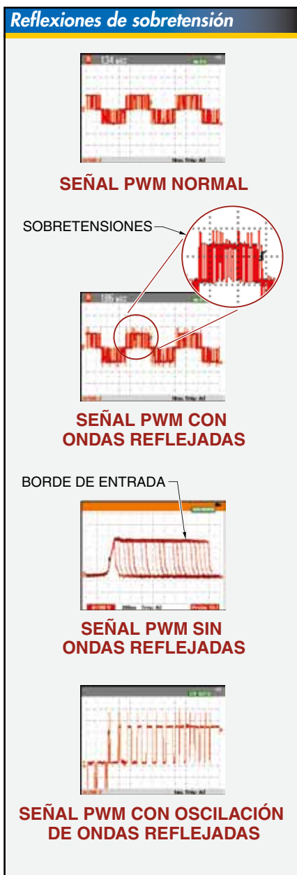
Figura 4-4. El mejor instrumento para detectar condiciones de sobretensión producidas por tensiones reflejadas es el osciloscopio portátil.
