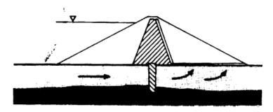
El rastrillo del tipo diafragma delgado, es resultado de los avances logrados en los procesos geotécnicos. El rastrillo se forma mediante la excavación, en longitudes de tramos de una zanja angosta estabilizada con lechadas que luego se rellenan de modo permanente con una mezcla de arcilla, arena y bentonita.
