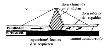
El rastrillo relativamente ancho y con zanjas poco profundas se rellena con arcilla compactada y forma la base del núcleo que está por encima. Es muy efectivo, en particular si se complementa con inyecciones, pero los costos de excavación lo limitan a profundidades máximas de zanja del orden de 10-20 m.
