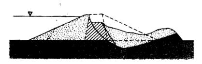
Inestabilidad (3): falla de la cimentación aguas abajo debido a sobresfuerzos efectivos de capas blandas y débiles.
