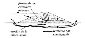
Erosión interna y canalización con migración de finos del núcleo, etc. Nótese la regresión del "canal" y la formación de cavidades internas. Puede iniciarse por la formación de grietas internas o por infiltración a lo largo del perímetro de la alcantarilla, etc.
