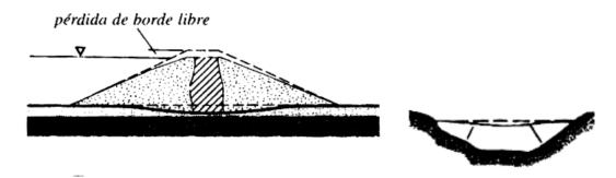
Sedimentación de la cimentación y el relleno (Deformación y agrietamiento interno). Nótense también los modos de deformación del valle transversal.
