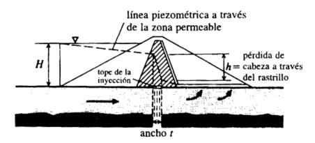
El rastrillo del tipo de zona inyectada, se emplea en la actualidad para un rango amplio de condiciones de cimentación debido a los desarrollos en las técnicas de lechadas, por ejemplo, las técnicas de inyección en aluviones. El rastrillo se forma por varias líneas
