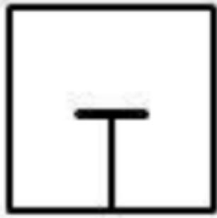
El trazo transversal indica que no se permite el paso de aire.
