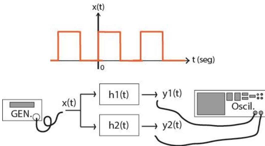
**Valores de señales para el ensayo:** El generador de funciones deberá configurarse como una señal cuadrada de frecuencia variable, sin offset y amplitud 5 voltios pico a pico.
