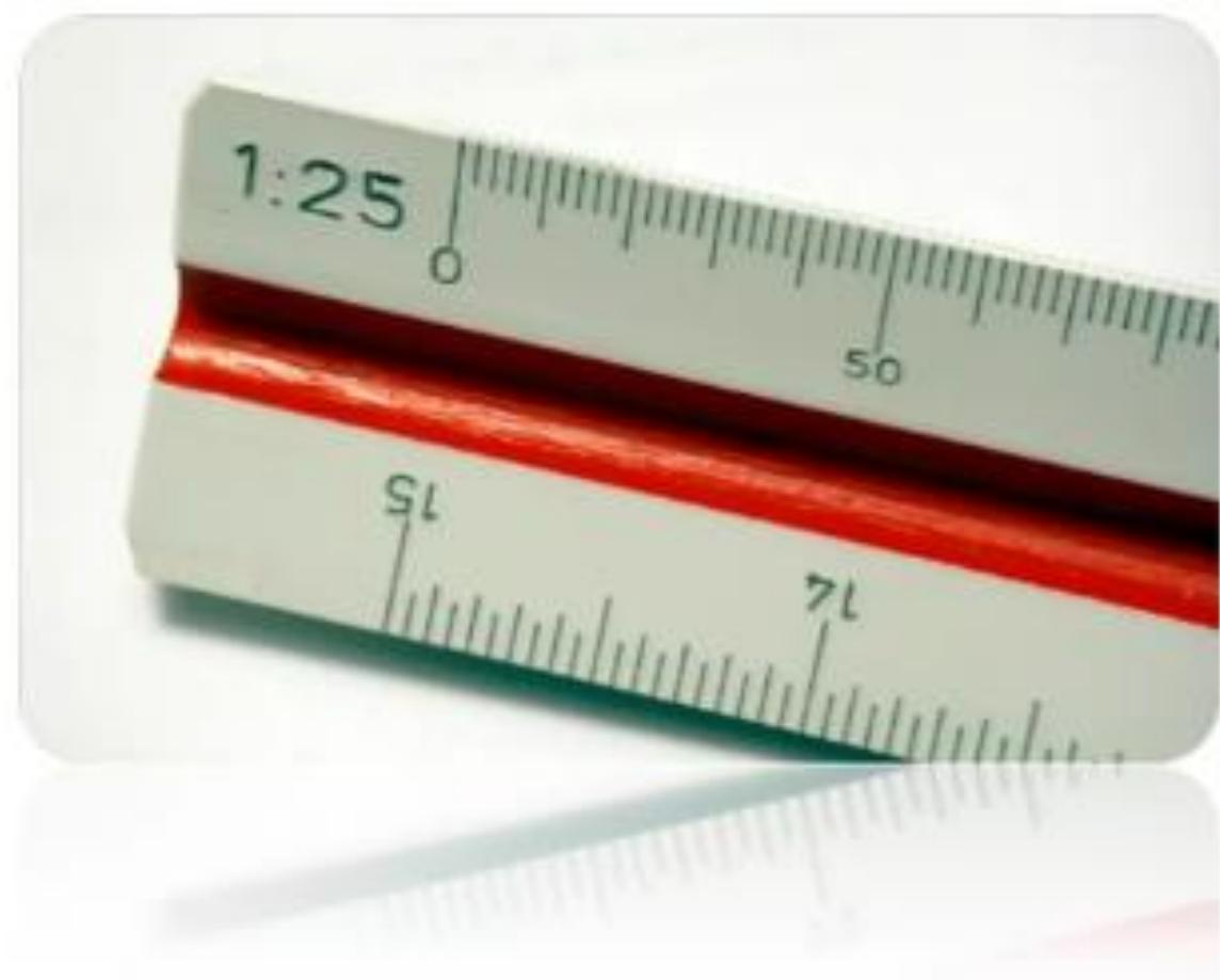
El escalímetro es una regla cuya sección transversal tiene forma prismática con el objeto de contener diferentes escalas en la misma regla. Se emplea para medir en dibujos que contienen diversas escalas. En su borde contiene un rango con escalas calibradas y basta con girarlo para ver la escala apropiada.
