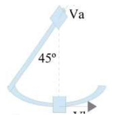
14 – Dado el sistema biela-manivela determinar la posición, velocidad y aceleración del pistón "P" teniendo en cuenta que OA es la mitad de AP y la manivela OA gira a velocidad angular constante " $\omega$ ". Determinar el ángulo de inclinación de OA que genere la máxima velocidad de P.
