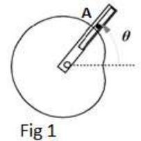
3 - El brazo robótico de la figura 2 posee un giro en el sentido contrario a las agujas del reloj y simultáneamente se extiende "L". Para la inclinación de  $\theta = 30^\circ$  que se muestra, la velocidad angular es constante de 0,20 rad/s,  $L = 2,5$  m, la velocidad con la que se estira el brazo es 0,5m/s y su aceleración es de  $-3m/s^2$ .
