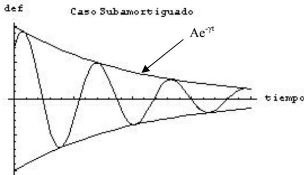
Como se ve en la figura, las oscilaciones son tales que su amplitud va decayendo. El caso mostrado corresponde a condiciones iniciales  $x(0) > 0$  y  $\dot{x} > 0$ . La fuerza del amortiguador disipa la energía disponible, y el movimiento cesa una vez que se disipa toda la energía que inicialmente se le comunica al sistema.
