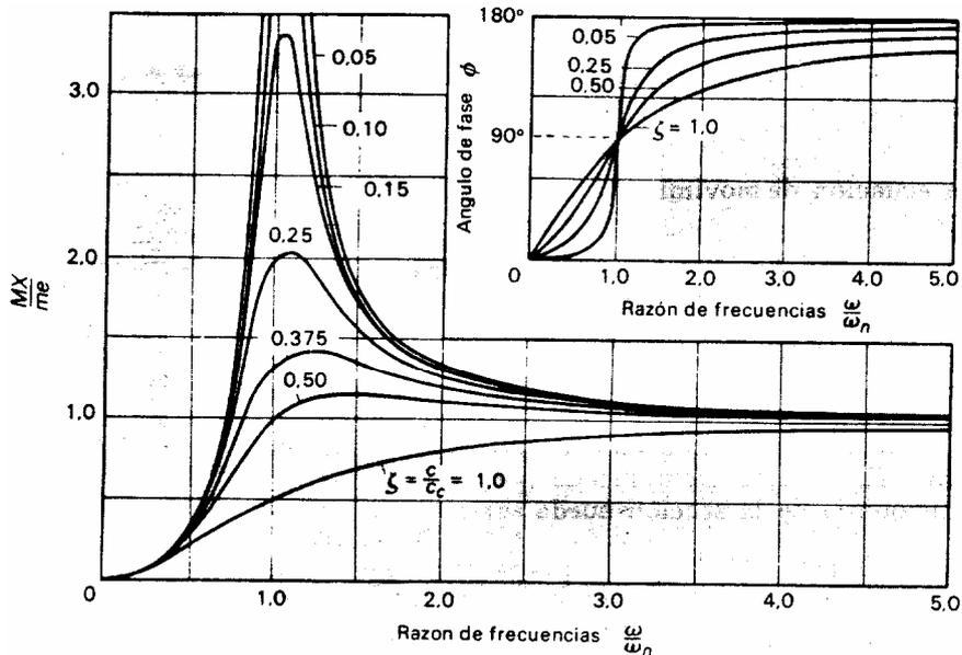
Fig. 3.2-2. Gráfico de las Ecs. (3.2-4) y (3.2-5) para vibración forzada con desbalance rotatorio.
