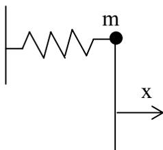
$K =$  Constante de proporcionalidad entre la fuerza “ $F$ ” y la deformación “ $x$ ”. El modelo físico para este oscilador armónico o lineal es el mostrado en la la figura. Si bien la masa se puede dibujar como un bloque o cuadro, se interpretará se comporta como una partícula.
