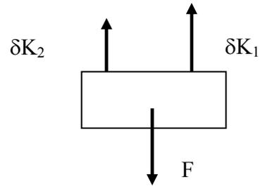
El diagrama de cuerpo libre para la masa “m” se muestra en el dibujo de la izquierda.
