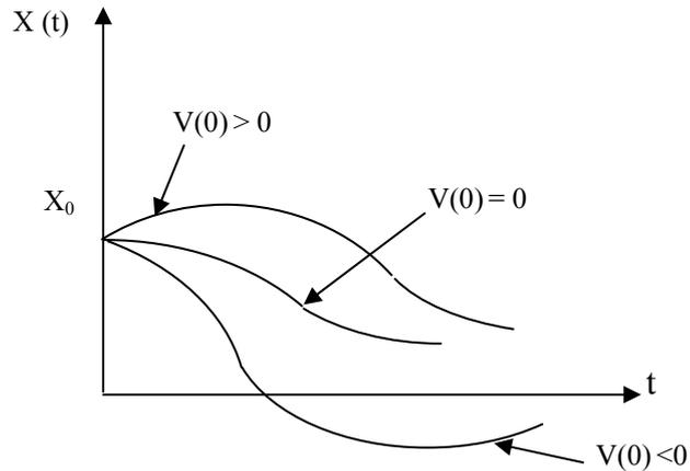
Tener velocidad inicial  $V(0)$  significa que se impulsa a la masa en la misma dirección que la deformación  $X(0)$ , por lo que el valor de la deformación primero aumentará para luego decaer bajo
