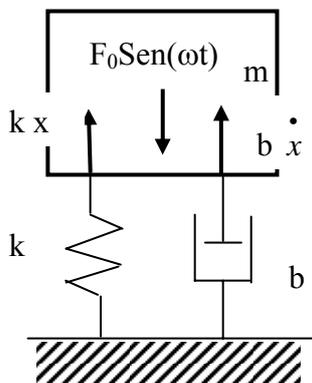
cuyos elementos son la masa ( $m$ ), el resorte ( $k$ ) y el amortiguador ( $b$ ). También se muestran las fuerzas que actúan sobre la masa: La fuerza forzadora  $F_o \text{sen} \omega t$ , la fuerza del resorte ( $kx$ ) y la fuerza del amortiguador ( $b \dot{x}$ ). Considerando un desplazamiento "x" desde la posición de equilibrio estático, positivo dirigido hacia arriba, se plantea la ecuación de movimiento:
