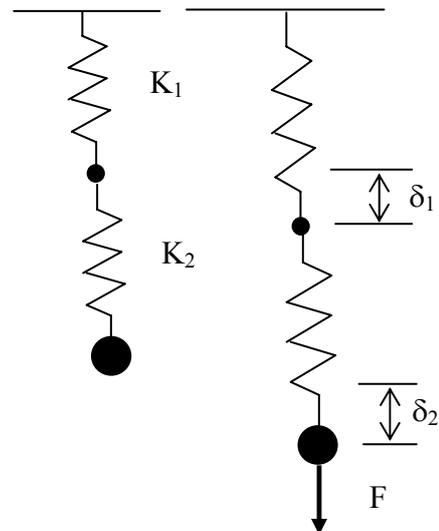
Se puede realizar una analogía con las resistencias en un circuito eléctrico. Las fuerzas serían los equivalentes a las tensiones, y las deformaciones equivalentes a corrientes eléctricas. Los resortes que tienen la misma deformación (el primer caso expuesto) pueden asimilarse a resistencias conectadas en serie (la misma corriente), en tanto que los resortes sometidos a la misma fuerza equivalen a resistencias conectadas en paralelo (la misma tensión aplicada).
