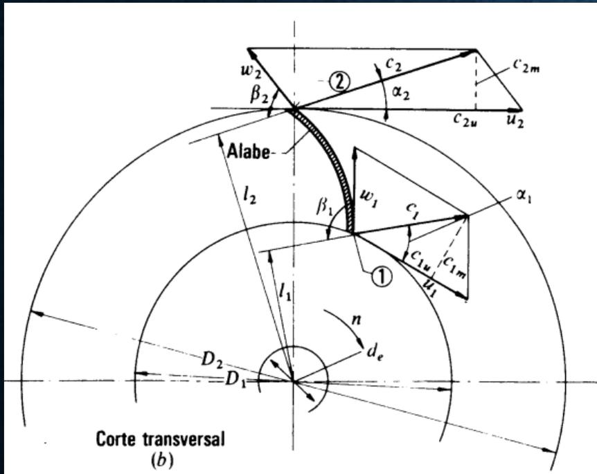
“La partícula de fluido ha sufrido, pues, en su paso por el rodete un cambio en la velocidad de  $\vec{c}_1$  a  $\vec{c}_2$ .”
