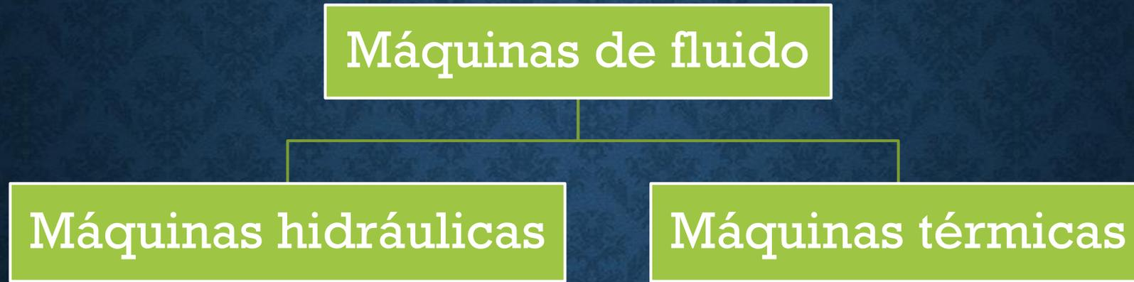
*Máquina hidráulica* es aquella en que el fluido que intercambia su energía no varía sensiblemente la densidad en su paso a través de la máquina, por lo cual en el diseño y estudio de la misma se hace la hipótesis de que  $\rho = cte$ .
