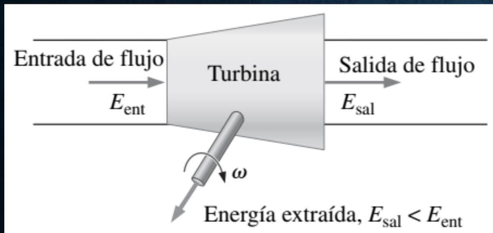
***El fluido en la descarga de la turbina experimenta una pérdida de energía, por lo general en forma de pérdida de presión.***
