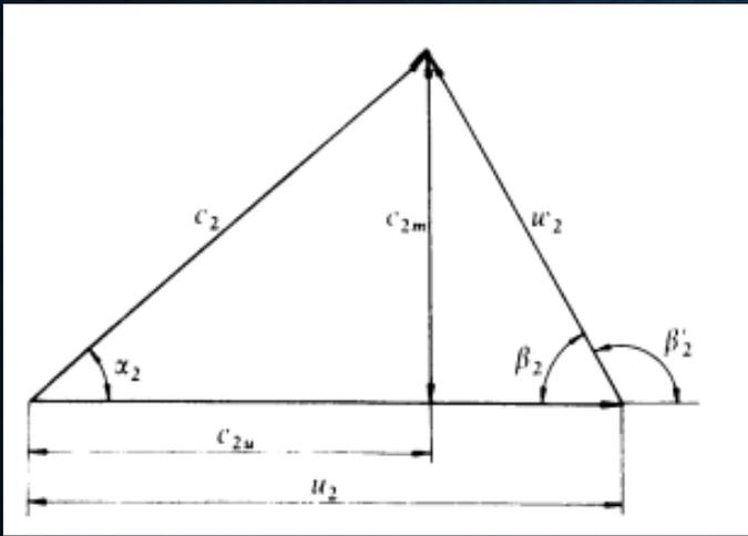
*Triángulo de salida*
