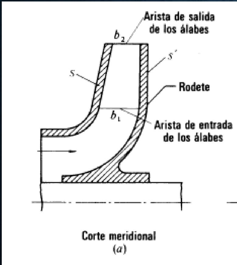
El corte por un plano que contiene al eje de la máquina, se llama *Corte meridional*, en el se representan en su verdadera forma las meridianas de las superficies de revolución de la máquina, como son las superficies interior y posterior del rodete  $s$  y  $s'$ .
