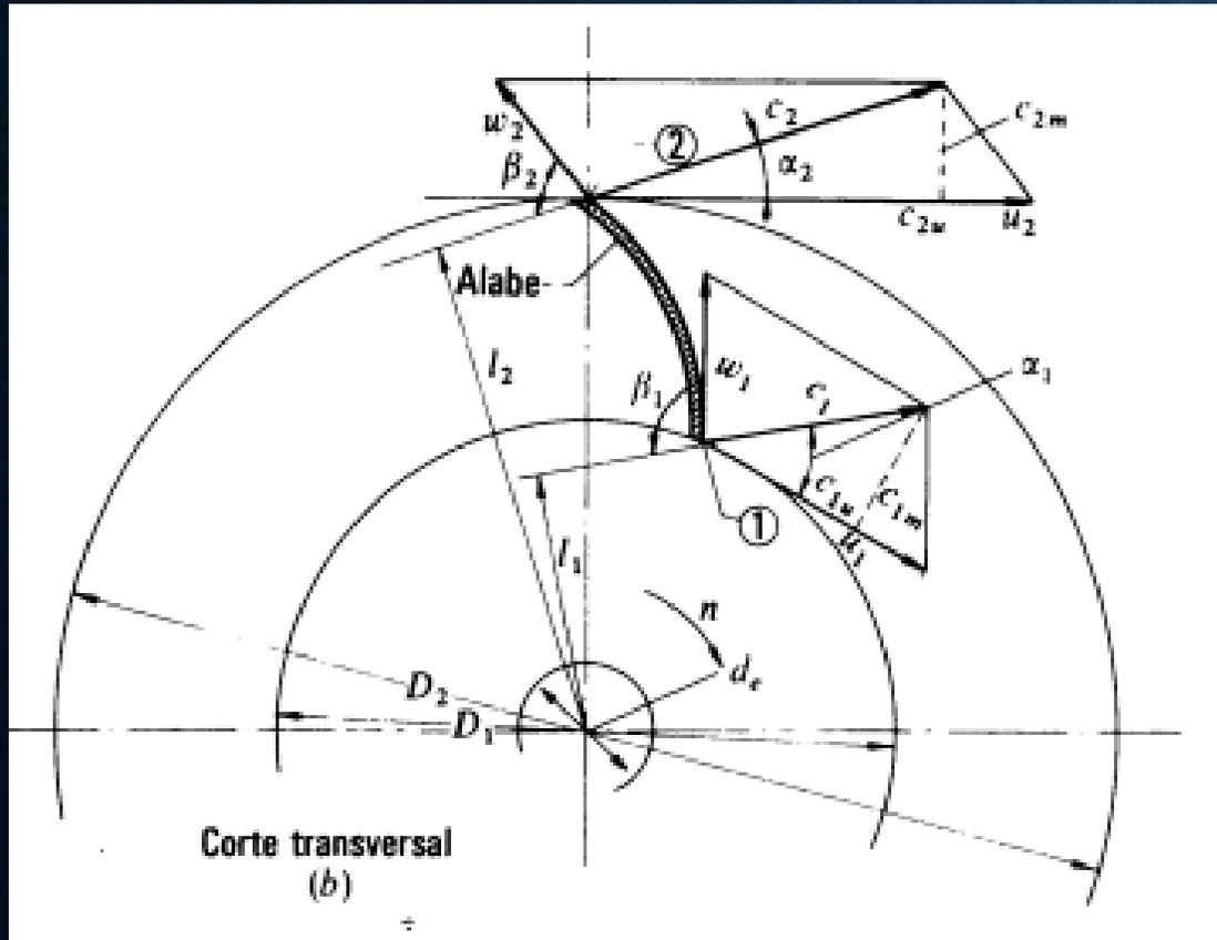
Se representa el *Corte transversal* por un plano perpendicular al eje. En el corte transversal de una bomba radial se ve el álabe del rodete en su verdadera forma: el álabe es una superficie cilíndrica con generatrices paralelas al eje de la máquina. Los diámetros de entrada y salida de los álabes  $D_1$  y  $D_2$  se acotan también en este plano, así como el diámetro del eje,  $d_e$ .
