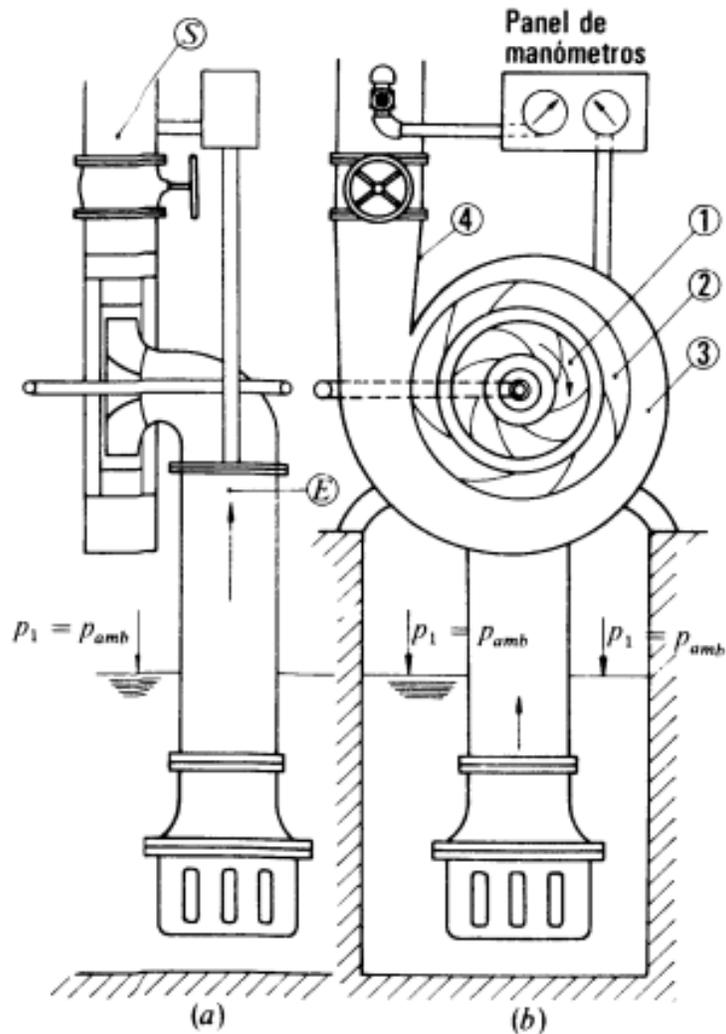
*Todas las pérdidas de energía que tienen lugar entre las secciones E y S son imputables a la bomba y disminuyen el rendimiento de la bomba; pero las pérdidas que tienen lugar antes de la sección E (en el tubo de aspiración) y después de la sección S (en el tubo de impulsión) son imputables a la instalación y disminuyen el rendimiento de la instalación (no de la bomba).*
