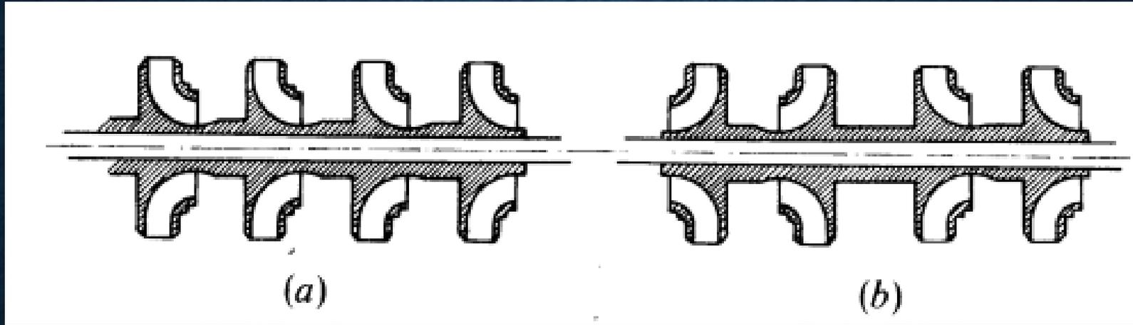
Cuando en las bombas se presentan varios escalonamientos, el caudal que sale de un rodete ingresa al siguiente, esto genera que en el caso a) se genere un gran empuje axial en la bomba, mientras que con la disposición de la bomba b) el empuje se encuentra equilibrado. Esto hace que la disposición de la bomba con un sistema escalonado como la situación b) sea preferible.
