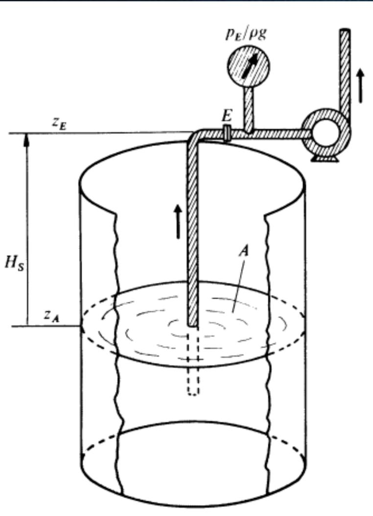
*$\Delta h$  varía con el punto de funcionamiento de la bomba. Generalmente interesa el  $\Delta h$  correspondiente al caudal nominal de la bomba, o caudal para el cual la bomba funciona  $\eta_{tot\ max}$ .*
