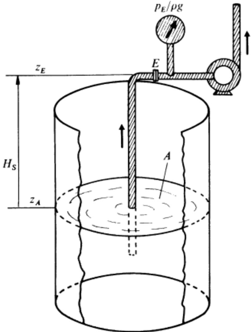
$H_E = \frac{p_E}{\gamma} + \frac{c_E^2}{2g} \rightarrow$  altura total a la entrada de la bomba referida a la cota  $z_E$
