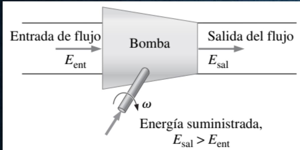
***El incremento de la energía hidráulica se experimenta como un aumento en la presión del fluido.***
