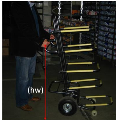
Fig. 3.8. Representación de la altura de agarre absoluta (hw)
