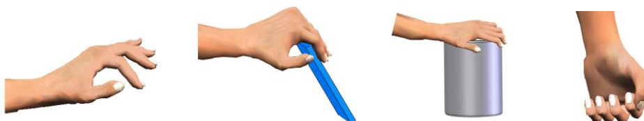
Fig. 4.7. Tipos de agarre: Pinza (dos primeras imágenes de izq. a der.), Palmar y Gancho.
