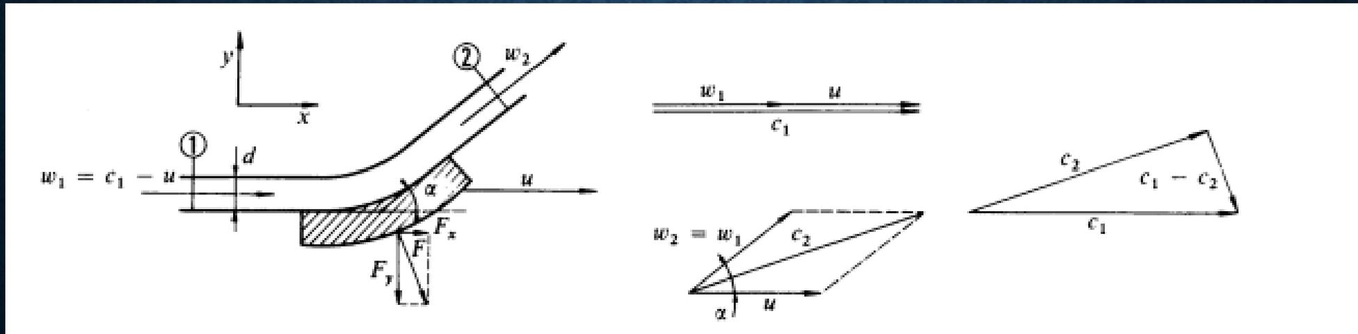
$$\vec{c}_2 - \vec{c}_1 = (\vec{w}_2 + \vec{u}) - (\vec{w}_1 + \vec{u}) = \vec{w}_2 - \vec{w}_1$$
