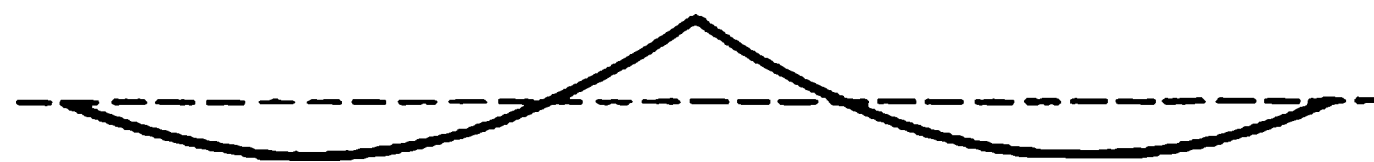
(b) onda cnoidal: amplitud finita en aguas poco profundas.
