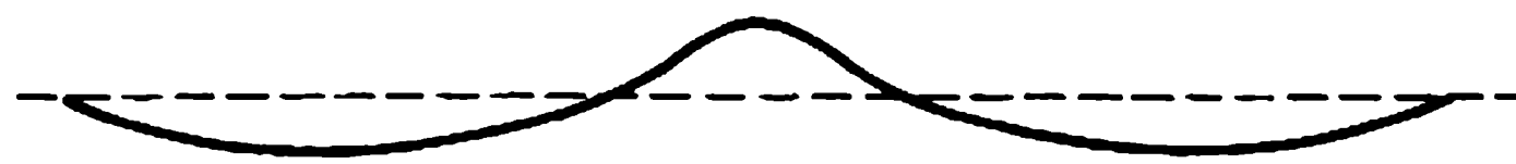
(b) onda cnoidal: amplitud finita en aguas poco profundas.
