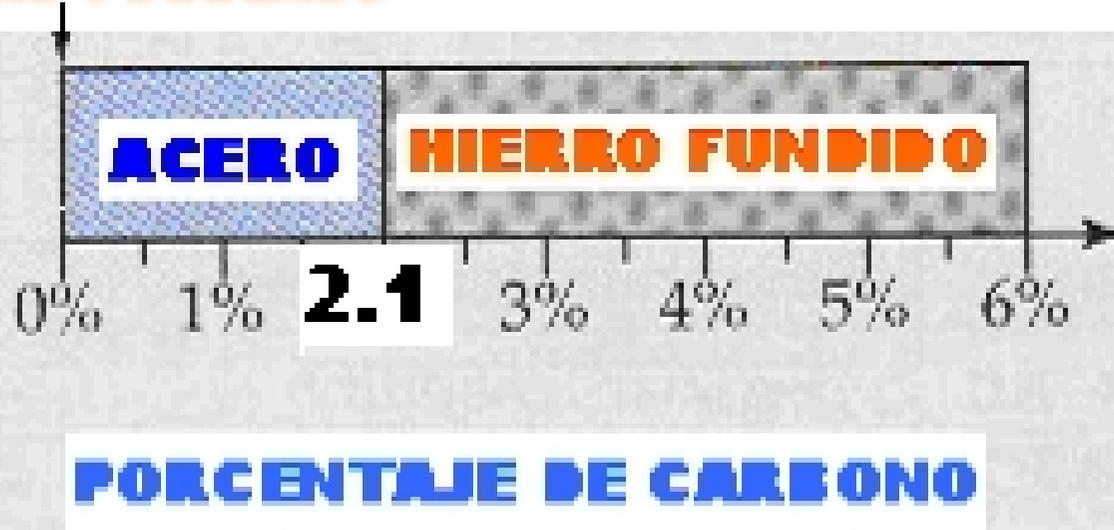
**DIFERENCIA ENTRE EL HIERRO PULVERIZADO, EL ACERO Y EL HIERRO FUNDIDO CON RESPECTO A SU CONTENIDO DE C(%)**
