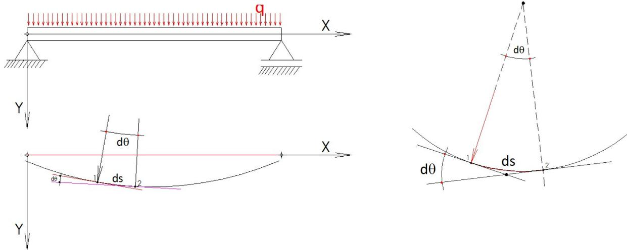
Se analiza la curvatura y sus tangentes en dos secciones cercanas y considerando que la curvatura es pequeña como ocurre en las estructuras reales
