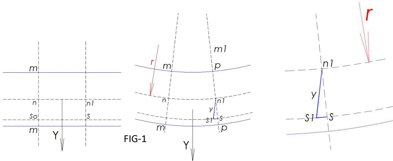
La deformación específica de una fibra a una distancia **y** del eje neutro
