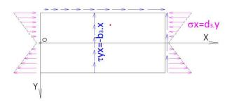
Cada plano a cualquier distancia X del origen esta sometido a una tensión axil en X y que varia según la distancia al eje X que se denomina eje neutro de tensiones
