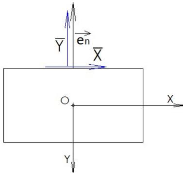
Tomando por ejemplo un borde de la placa paralela a X tendremos para esta parte del contorno que la normal  $\vec{e}_n$  es paralela al eje Y, de modo que  $\alpha=0$  y  $\beta=+/-1$  con lo que las ecuaciones de contorno quedan:
