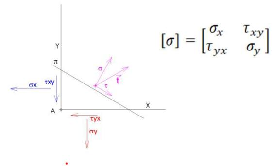
Este sistema de cargas exteriores genera en cada punto de la placa, en un sistema ortogonal, un estado plano de tensiones caracterizado por los valores:  $\sigma_x, \sigma_y, \tau_{xy}$
