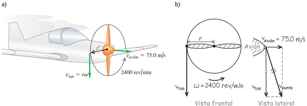
a) Según la figura 9.13b y la ecuación (9.13), la magnitud de la velocidad  $v_{\text{total}}$  está dada por
