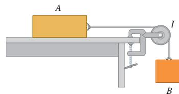
**9.86.** La polea de la figura 9.36 tiene 0.160 m de radio y su momento de inercia es de  $0.480 \text{ kg} \cdot \text{m}^2$ . La cuerda no resbala en la polea. Use métodos de energía para calcular la rapidez del bloque de 4.00 kg justo antes de golpear el piso.
