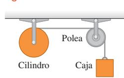
miento entre la cuerda y la superficie de la polea. El cilindro uniforme tiene masa de 5.00 kg y radio de 40.0 cm. La polea es un disco uniforme con masa de 2.00 kg y radio de 20.0 cm. La caja se suelta desde el reposo y descende mientras la cuerda se desenrolla del cilindro. Calcule la rapidez que tiene la caja cuando ha caído 1.50 m.
