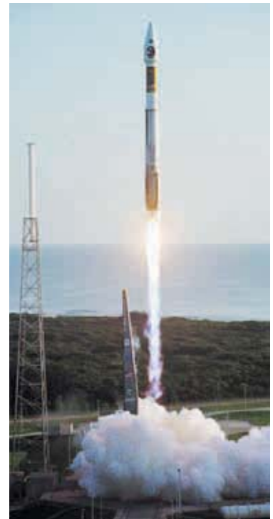
8.33 Con la finalidad de proveer suficiente empuje para elevar su carga en el espacio, el vehículo de lanzamiento Atlas V expelle más de 1000 kg de combustible quemado por segundo con una rapidez de casi 4000 m/s.
