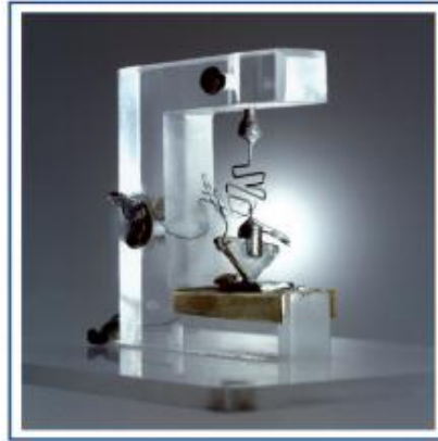
Figura 5. El transistor de punta de contacto tenía una base de germanio y una punta de oro, que era presionada hacia abajo por un clip. Fue el inicio de la miniaturización.
