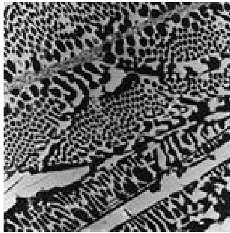
Microestructura de la fundición blanca
