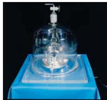
1.4 El objeto de metal encerrado cuidadosamente dentro de estos envases de cristal es el kilogramo estándar internacional.
