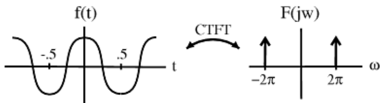
Figure 13.23: La figura muestra la función coseno, f(t) = \cos(2\pi t) , y su CTFT.
