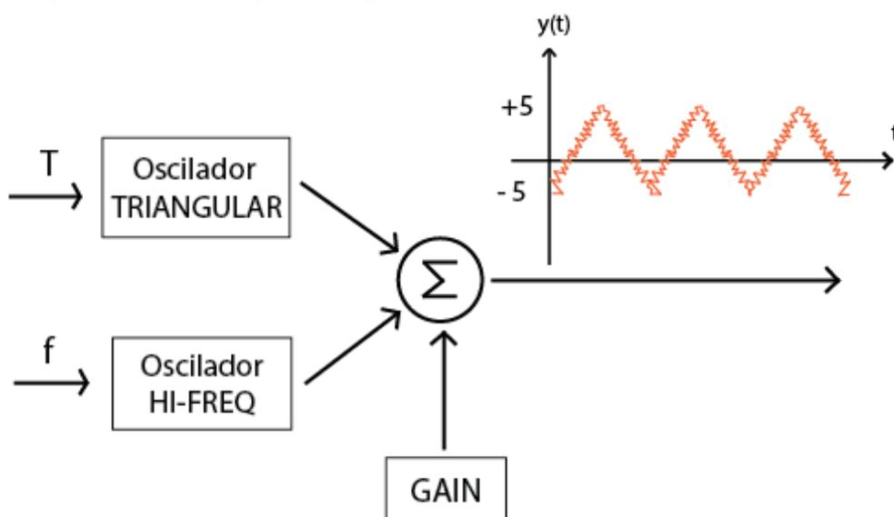
El sistema permite 3 parámetros de entrada, que son, el periodo "T" del generador de onda triangular, la frecuencia de las componentes de alta frecuencia y la ganancia que determina el offset de la señal resultante. Suponiendo que el compositor ingresa  $T=0,0005$ ,  $f=17\text{KHz}$  y  $\text{GAIN}=5$ , se pide:
