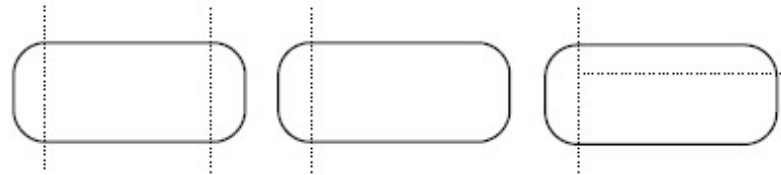
Figura 6.3 Esquema de las roturas más habituales de un recipiente cilíndrico
