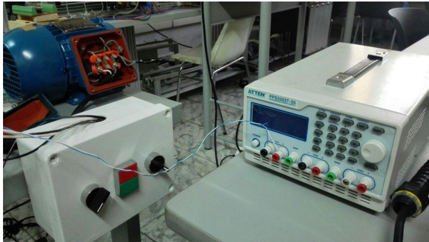
Ilustración 45 Fuente de alimentación de 0 a 10 V dc
