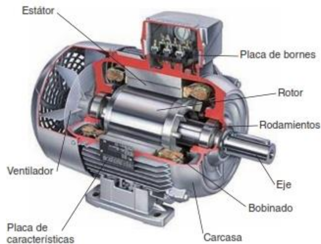
Ilustración 4 Sección de motor eléctrico
